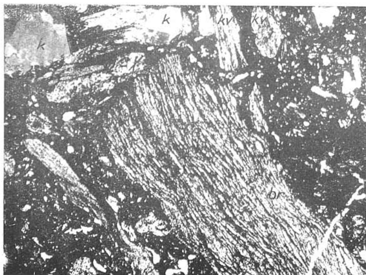
Obr. 2. Psefitická fácia hematitovej rudy. Kataklázované úlomky žilného kremeňa (k) fialových bridlic (br) a kvarcitov (kv). Hematit (čierny) je súčiastkou kremito-hematitového tmelu. + nikoly, zv. 10×. Foto Vrbovský.
